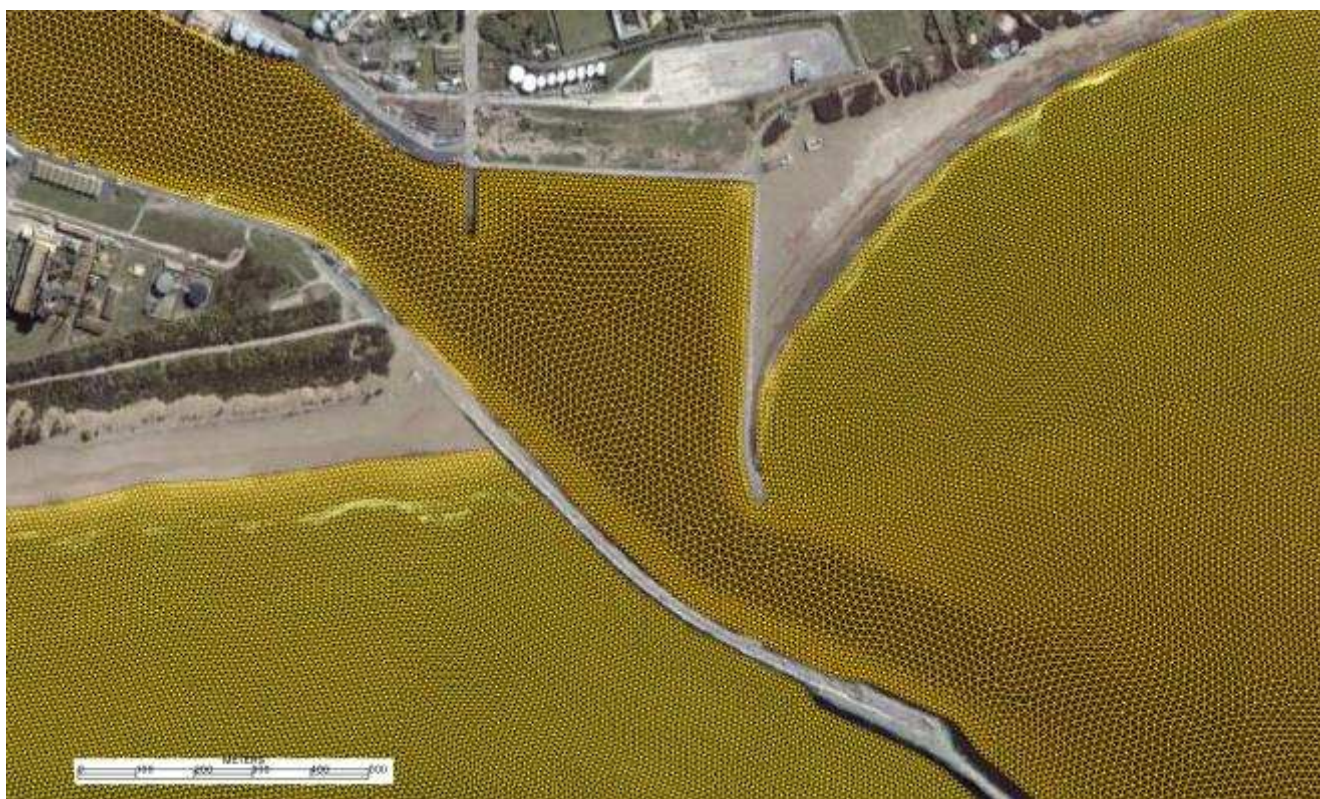
Figura 9: Detalle de la malla en el área portuaria, para la condición geométrica Actual.
