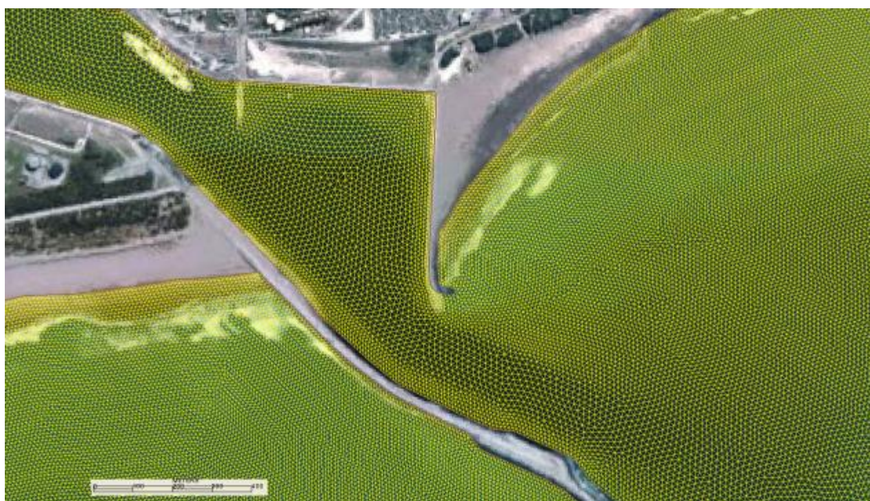
Figura 17: Detalle de la malla en el área portuaria para el Layout Futuro 4, Escollera Norte Modificada (alargada paralelamente a la escollera Sur) y Sin Espigón de defensa.
