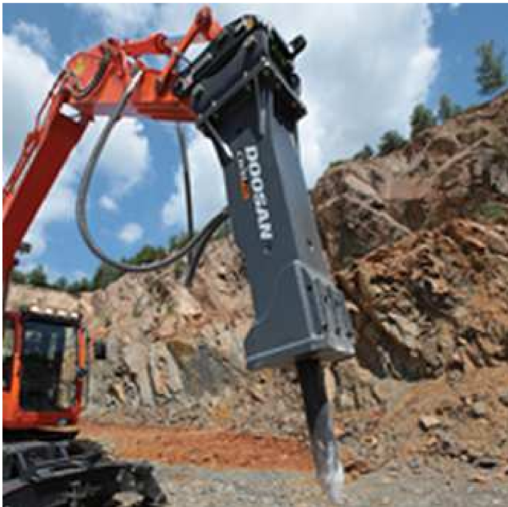
Figura 18: Retroexcavadora con martillo hidráulico.
