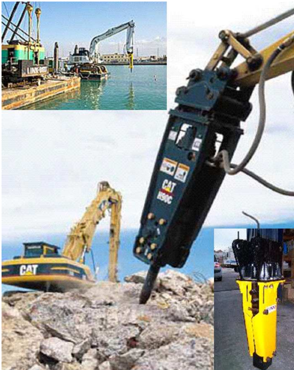
Figura 26:Retroexcavadora y accesorio martillo hidráulico y pinza.
